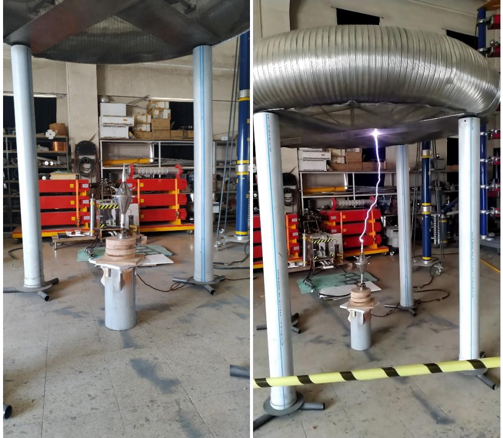
Resim-1/Pic-1: Yıldırım Darbe Test Sistemi ve Erken Emisyon Zaman Kazancı Test Görşeli/ESE Test Pic. * FOREND -PETEX L/0001
